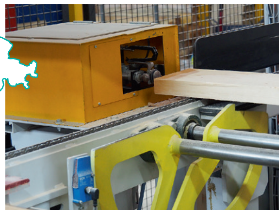
Der Herzstück: Schwingungsgeber und -sensor für die Messung des dynamischen E-Moduls
