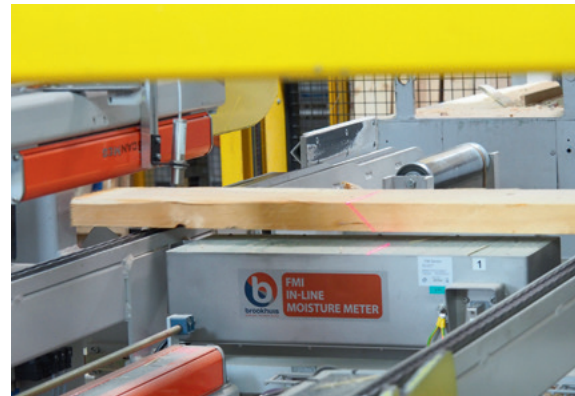
Der FMI In-Line Moisture Meter ermittelt die Holzfeuchte im Querdurchlauf
