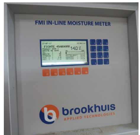
Am Bildschirm ist das Ergebnis der Feuchtemessung ablesbar
